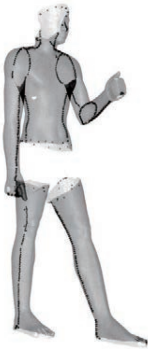
図 11-2: X線撮影により、この像は個々の銅板をリベットでつなげて作られていたことが明らかになった。鑄造技法は用いられていなかった。
